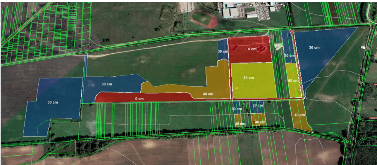
4-5. ábra: A vizsgált terület a talajtani feltárás és humuszos réteg vastagságok ábrázolásával
