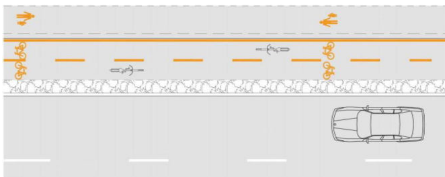
11. Ábra: Elválasztott gyalog- és kerékpárút jellegrajza
