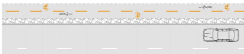
12. Ábra: Önálló kétirányú kerékpárút jellegrajza
